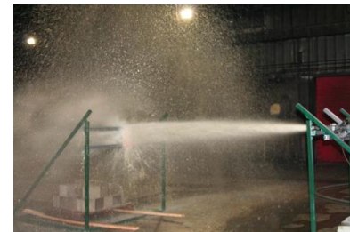
Prueba de conductividad del chorro realizada en UL
