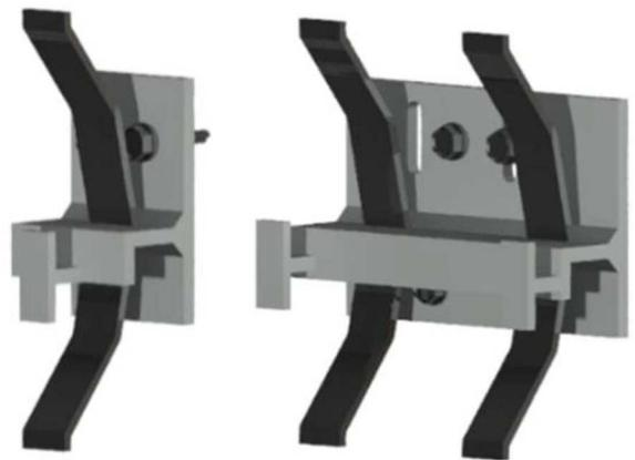
**Imagen 5.** Flejes de acero inoxidable insertados en los orificios de las grapas de sujeción.
