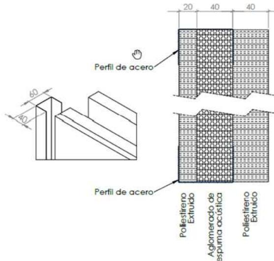
**Figura 4.** Sección horizontal de panel de partición interior MULTIZERO
