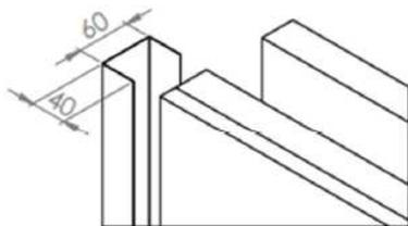
**Figura 8.** Vista isométrica del panel MULTIZERO de partición interior con perfil de sección U inserto.
