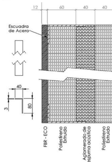
**Figura 1.** Sección horizontal del panel de fachada MULTIZERO
