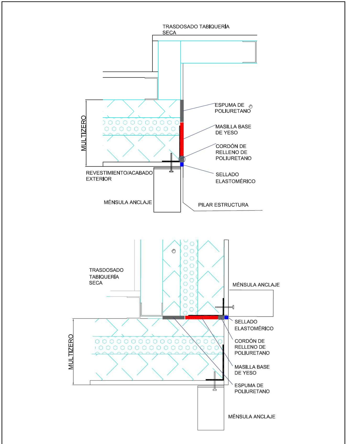
**Figura 16:** Sección horizontal - Encuentro entre cerramiento de fachada completo y pilar estructural
