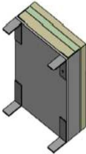
**Figura 2.** Vista isométrica del panel MULTIZERO de fachada con ménsulas fijadas en sus cuatro vértices.
