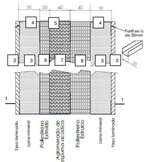
**Figura 5.** Sección horizontal del cerramiento completo compuesto por sistema de partición interior MULTIZERO y trasdosados interiores a ambos lados
