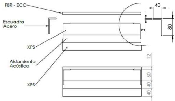
**Figura 6.** Planta del perfil angular acotado y sección horizontal del panel MULTIZERO de fachada con perfil angular inserto.
