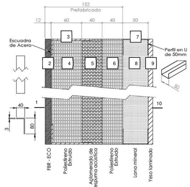
**Figura 3.** Sección horizontal del cerramiento completo compuesto por sistema de fachada MULTIZERO, revestimiento exterior y trasdosado interior
