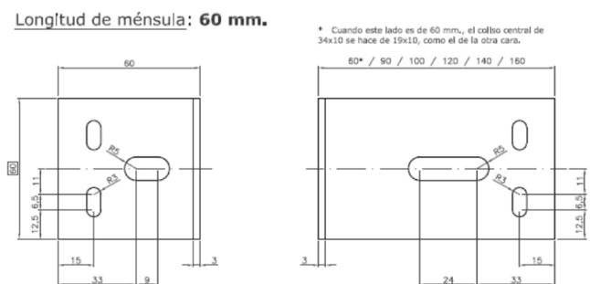
Figura 10. Ménsulas de fijación panel - forjado
