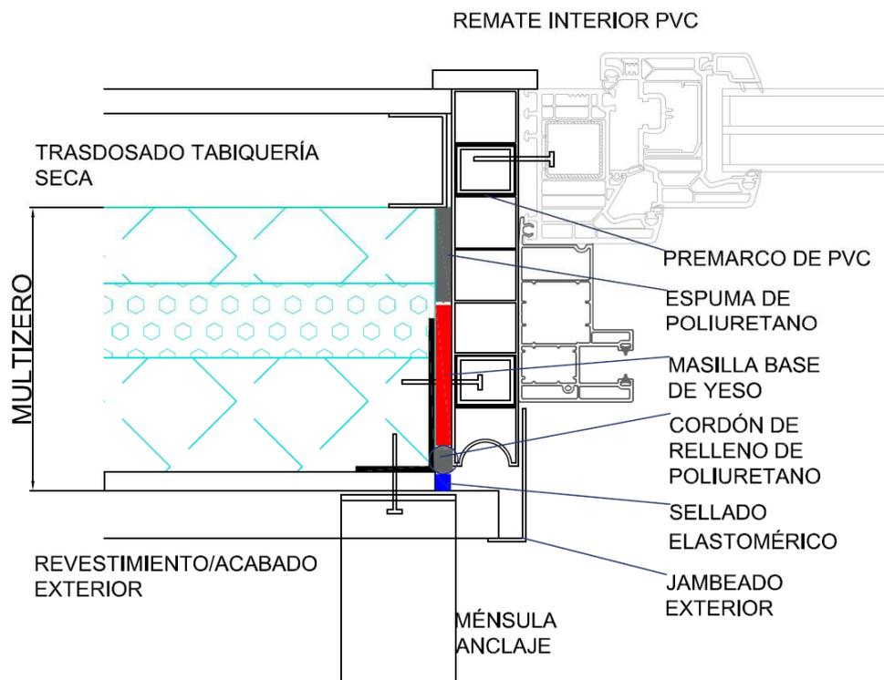
**Figura 14:** Sección horizontal – Junta vertical cerramiento de fachada completo (con trasdosado interior)
