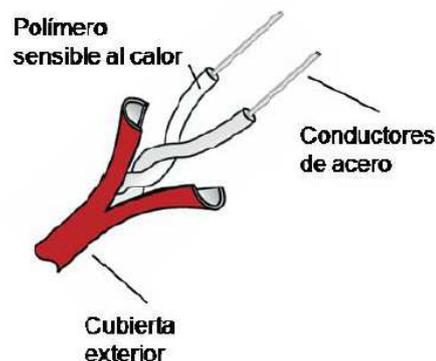
Figura 9.- Descripción de la configuración del cable térmico
