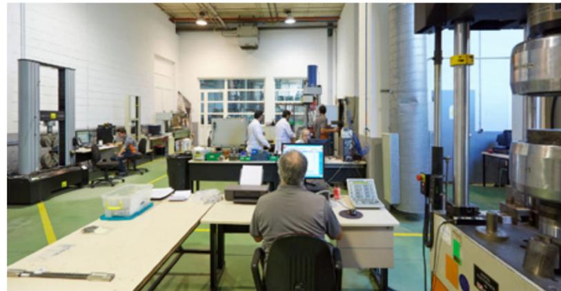
El **laboratorio de ensayos mecánicos** cuenta con capacidad para la realización de ensayos estáticos y dinámicos acreditados de acuerdo a la norma **UNE-EN ISO/IEC 17025**, tanto a temperatura ambiente como a alta y baja temperatura (tracción, fatiga, compresión, dureza, impacto Charpy, ensayos de mecánica de la fractura...).
