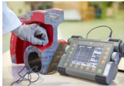
El laboratorio de Ensayos No Destructivos (END) de TECNALIA ofrece ensayos de control de calidad y apoyo en otro tipo de análisis y estudios que precisan de la localización y dimensionamiento de defectos, anomalías y daño.
