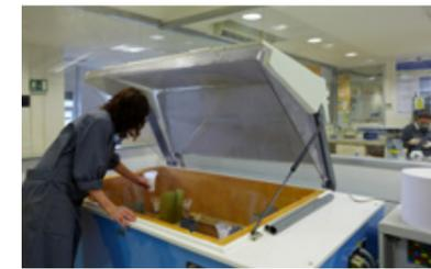
El **laboratorio de corrosión y electroquímica** ofrece servicio de **ensayos de corrosión y envejecimiento** de materiales y sistemas de protección, bajo especificaciones de cliente o normas nacionales e internacionales, para los que cuenta con acreditaciones de acuerdo a la norma **UNE-EN ISO/IEC 17025**.
